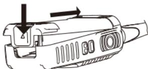
欲取下电池，请先关闭对讲机电源，然后将对讲机背面底部的闩锁向上推，取出电池。
